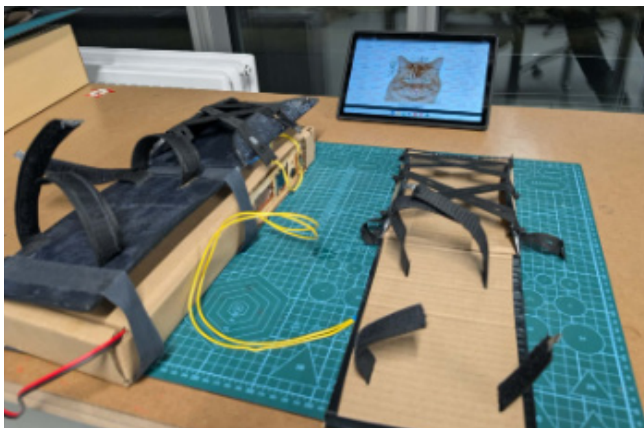
Rycina 1. Stanowisko do ćwiczeń wyprostowania nadgarstka z wykorzystaniem urządzenia Balonikotron
