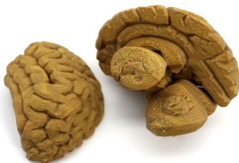
Rycina 4. Trójwymiarowy model mózgu z wyodrębnioną zmianą nowotworową wykonany w technologii FDM z wykorzystaniem filamentu ABS
