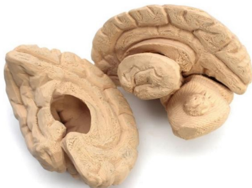
Rycina 6. Model anatomiczny mózgu z guzem wytworzony metodą FDM (PLA) przy zwiększonym stopniu wypełnienia struktury (80%); widok elementów po separacji
