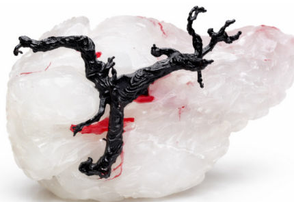
Rycina 9. Spersonalizowany model wątroby wykonany metodą hybrydową (wytwarzanie przyrostowe + odlewnictwo silikonowe) z zatopioną strukturą żyły wątrobowej
