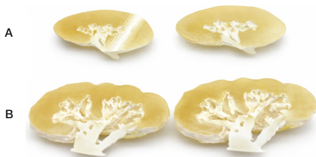
Rycina 11. Trójwymiarowy model nerek z wyodrębnioną zmianą nowotworową wykonany w technologii MJP (ProJet 3500 HD Max; VisiJet M3 Crystal/VisiJet S300): (A) model nerki zdrowej, (B) model nerki ze zmianą nowotworową
